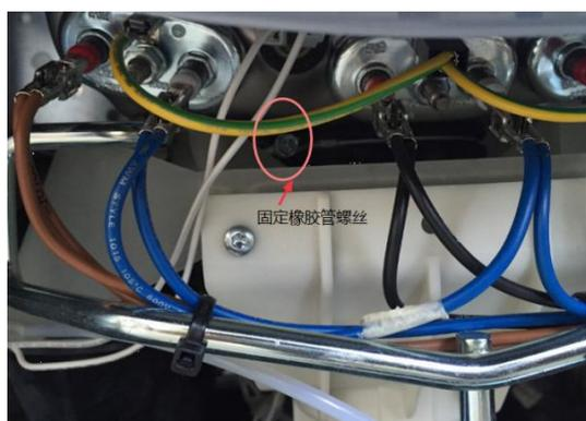
4.拆下 4 个排水阀的固定螺丝（四个角各一个）。
