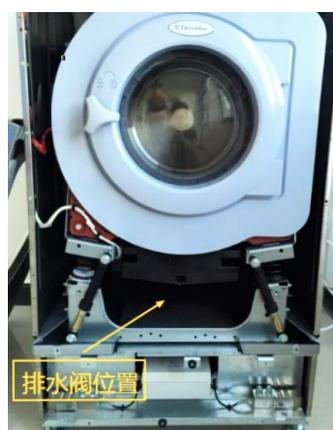
2. 拆下排水阀黑色塑料挡板（用手扶着两端，往外掰即可取出）。
