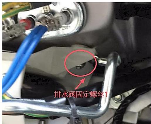
5.用手扶住排水阀两端，往下拉取出“排水阀”即可取出，清洁滚筒中杂物。
